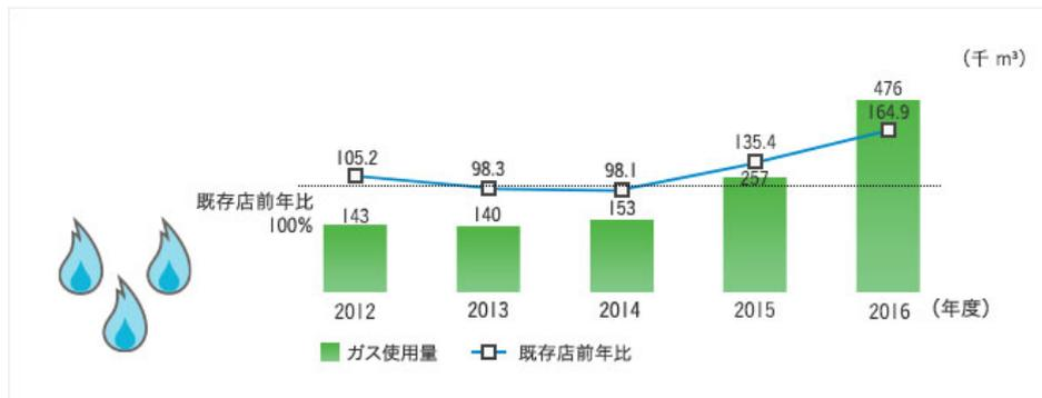
2015、2016年度のガス使用量の増加は空調のGHP※、ガスコージェネレーションなどの導入によるものです。それにより電気使用量が削減され単位あたりのエネルギー使用量の削減を図っています。
